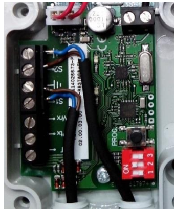
Figur 17: Tilslutning af medkørende sikkerhedskontaktlister til JCM senderen RB3R686
